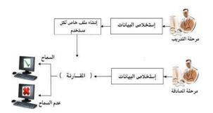
الشكل رقم (2): آلية عمل ديناميكية المفاتيح كأسلوب مصادقة على المستخدم
