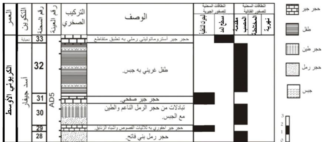
شكل 5: التتابع الرسوبي العمودي الرسوبي من قمة تكوين أسد جيفار مع الجزء السفلي لتكوين دمبابة ، موضحة عدد السحن الرسوبية المسجلة و مكان أخذ العينات ، بالإضافة الى لنطاقات الرسوبية التي ينتمي لها هذا القطاع الرسوبي
