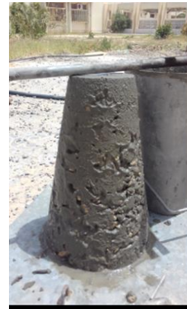
الشكل رقم (2) يبين شكل اختبار الهبوط في الخرسانة
