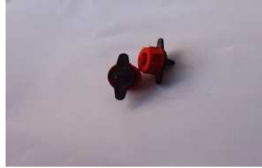
شكل 2 صورة فوتوغرافية تبين نوعية المنقّطات المصرية التي تركب على جدار الخط الفرعي.
