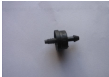
شكل 4 صورة فوتوغرافية تبين نوعية المنقّطات الإيطالية التي تركب على جدار الخط الفرعي.
