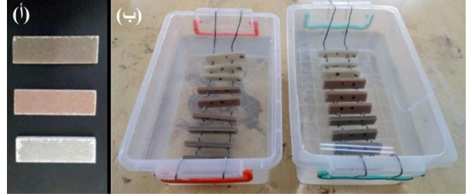
شكل 6: (أ) عينات الاختبار بعد تجهيزها حسب مواصفة الاختبار؛ (ب) العينات مغمورة في وعاء ماء البحر (إلى اليمين) ووعاء الماء العذب (إلى اليسار)
