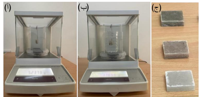
شكل 4: (أ) وزن العينة وهي معلقة في الهواء؛ (ب) وزن العينة مغمورة في الماء؛ (ج) شكل العينات المختبرة
