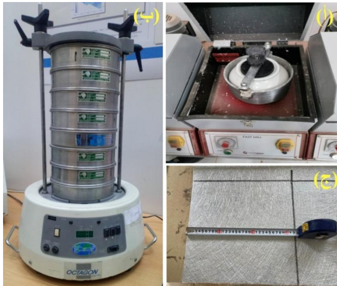
شكل 1: (أ) المطحنة العملية، (ب) الهزاز الكهربائي مثبت عليه المداخل، (ج) الألياف الزجاجية
