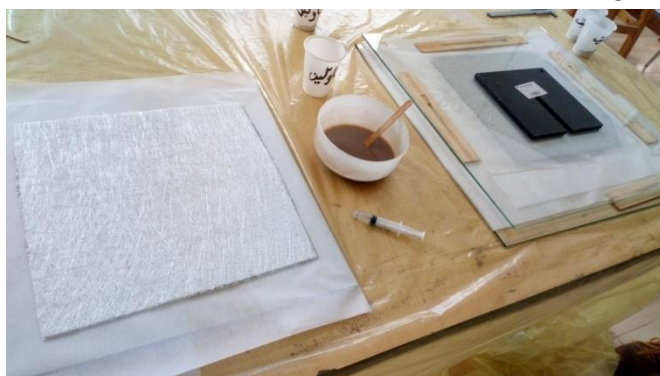
شكل 2: إلى اليمين أحد العينات بعد الانتهاء من تجهيزها؛ في الوسط خليط حبيبات الكاولين مع البوليمر قبل إضافة المصلد إليه؛ وإلى اليسار لوح زجاجي مثبت عليه قطعة من الورق المشحم وفوقها أحد طبقات الألياف العينات المتحصل عليها بعد أن تم قص وتسوية حوافها بإزالة الزوائد منها
