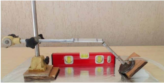
شكل 8: تجهيز العينة والموقد لاختبار الاحتراق
