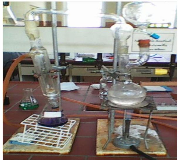
شكل 8.3 جهاز كداهل لتقطير النيتروجين
