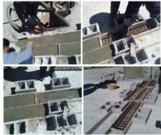
شكل 3: خطوات صب العجينة الاسمنتية داخل القوالب الخشبية
