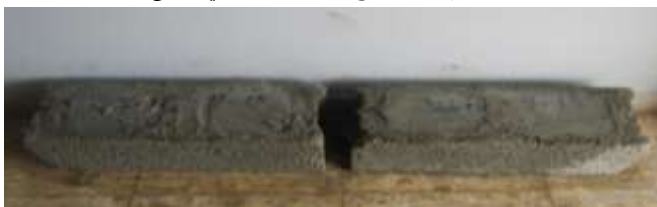
شكل رقم 11 يوضح الطوب الاسمنتي المصمت مملوء بالحقق
