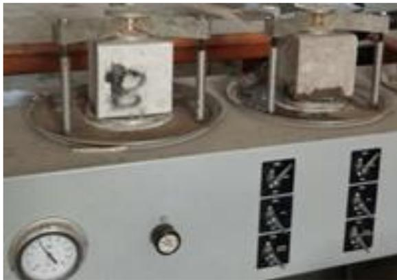
الشكل 3: المخطط التوضيحي والاعدادات لتجربة اختبار النفاذية.
