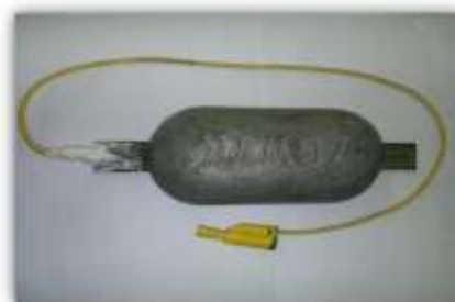
Figure. (2) sacrificial zinc anode.
